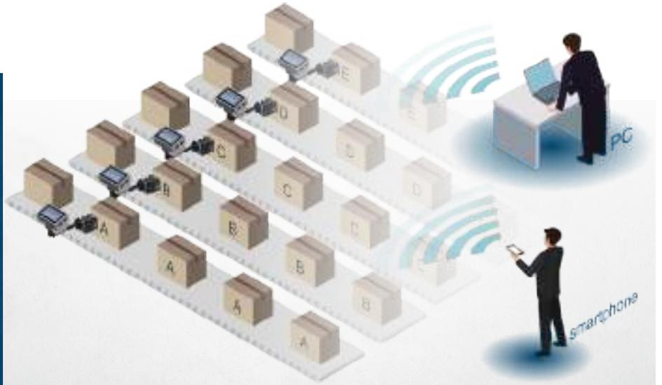
Los supervisores pueden controlar a distancia para cambiar las plantillas de impresión y modificar el contenido. Además, pueden comprobar el estado de la impresión y la corrección del contenido de los mensajes de impresión.
